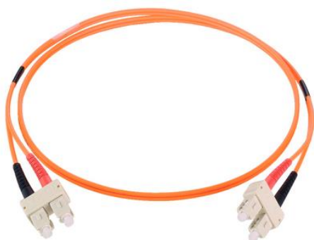
Figur 4.7 Modus: Multimode, Fibertype: 62.5/125 \mu m. Side A og B: SC. Lengde 20meter. Transmission: Duplex
