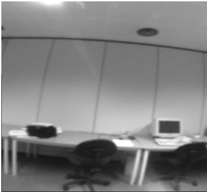
Figur 6.7 – Viser hvordan bildene blir når kameraene ikke er kalibrert. Her kan man enklest se dette ved at taklisten går i en jevn bue i øverste del av bildet.
