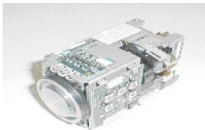
Figur 3.6 CCD-kamera brukes for stereosynet i Hessdalen.
