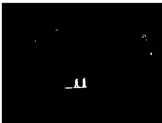
Figur 4.21: Bildeanalyse - thresholdet bilde etter at maske er ganget inn og hvite objekter har økt i størrelse
