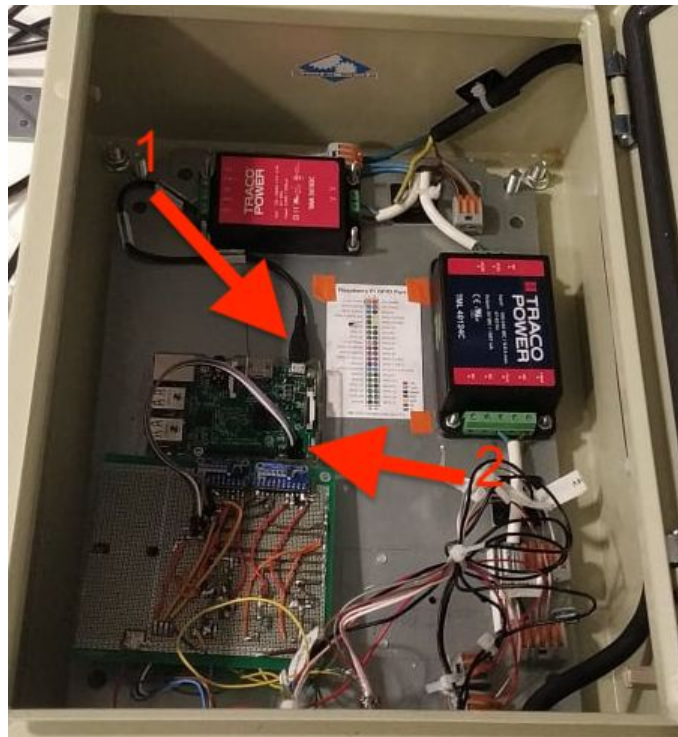
Figur 8.4. Bytte av hovedenheten.
