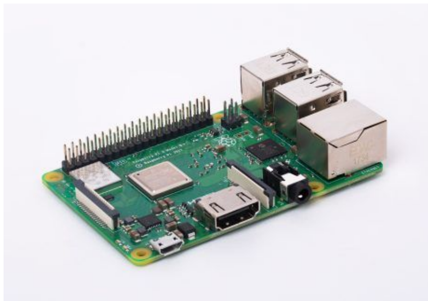
Figur 5.1. Bilde av en raspberry Pi 3 b+ (Raspberry Pi Foundation, 2018).
