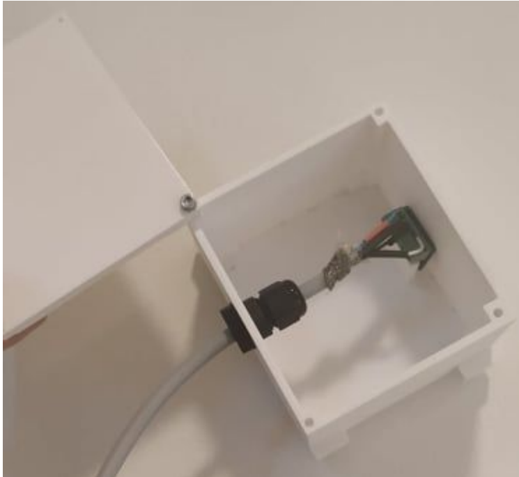
Figur 6.16. Monteringsboks for lufttrykksensor.
