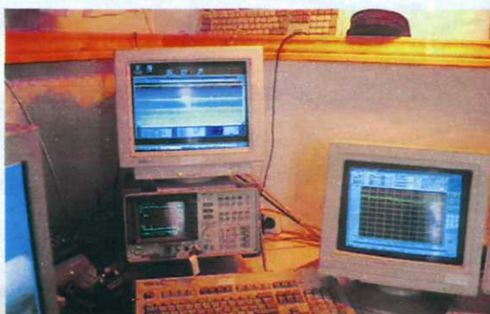
Il ricevitore Inspire del Cnr capta i fenomeni luminosi e li traduce in grafici. Le righe verticali individuano un segnale sconosciuto, il Comb Signal, attualmente allo studio dei ricercatori.
