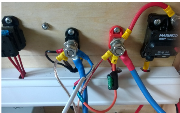
Figur 4.5: Knutepunktet for sammenslåing av batteriene og strømuttak for enheter
