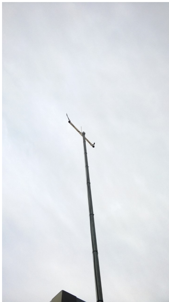
Figur 4.6: Masten med sensorer for vindretning- og hastighet montert på toppen
